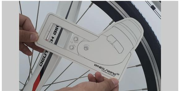
2 설치 가이드를 이용해 발전기 헤드 끝부분이 림 끝에 닿도록 설치 위치 확인
